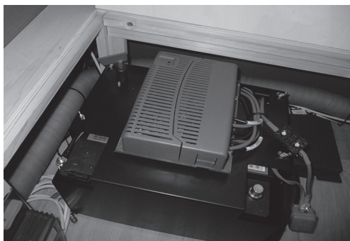
Afb. 63: Accu-afdekking met besturing voor Mover (optioneel)
