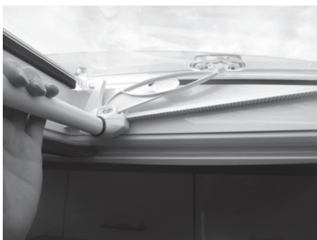
Afb. 122: Dakluik 400x400 mm / VisionStar 700x500 mm bedienen
