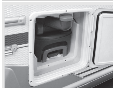
Afb. 50: Fecaliëntank met spoelwater-vultuit
