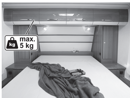
Afb. 55: Hangkasten in het slaapgedeelte
