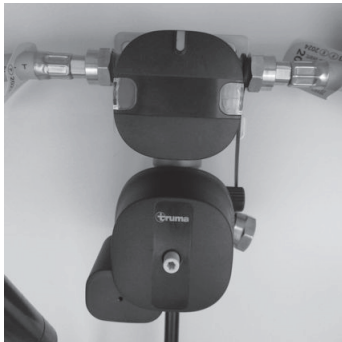
Afb. 76: Gasinstallatie (met Eis-Ex en display op afstand)
