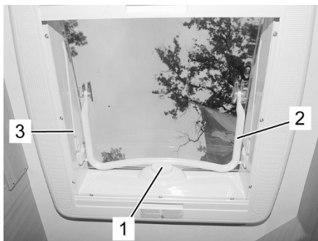
Fig. 124: Operating the Midi Heki / Mini Heki plus
