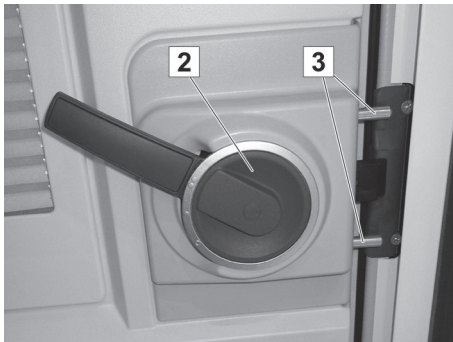
Afb. 17: Deur gesloten en geborgd
