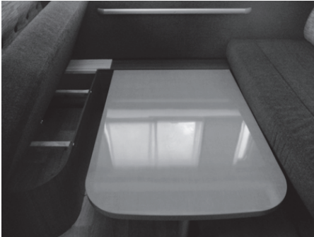
Afb. 189: Tafel ingehangen in de onderste rail.
